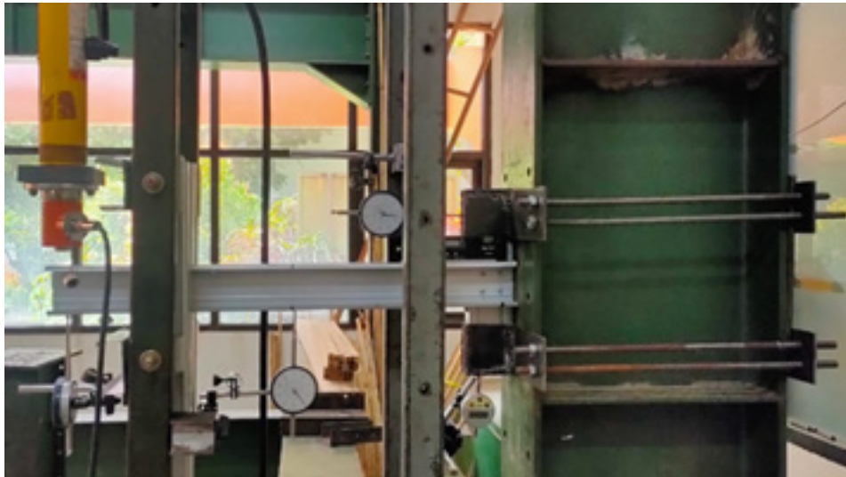
Gambar 2. Pengujian Balok Material CFS Tipe C
