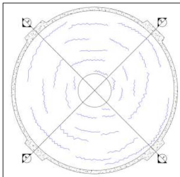
Gambar 5. Kerusakan Retak Pada Sisi Bawah Kerucut Silo
